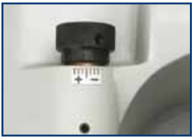
2 Réglage de profondeur micrométrique.
